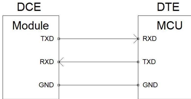
图表 7：串口三线制连接方式示意图
