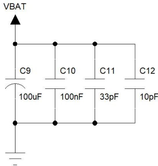
图表 3: VBAT 输入参考电路
