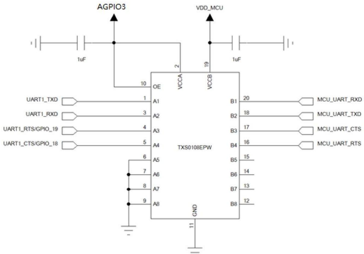
此电路采用的是电平转换芯片是 TI 的 TXS0108E，8 位双向电压电平转换器，适用于漏极开路 and 推挽应用，最大支持速率：
