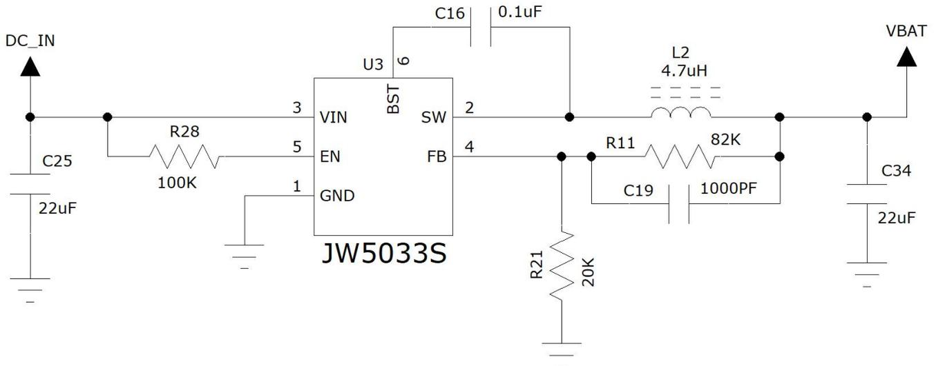
图表 6: DCDC 供电输入参考设计
