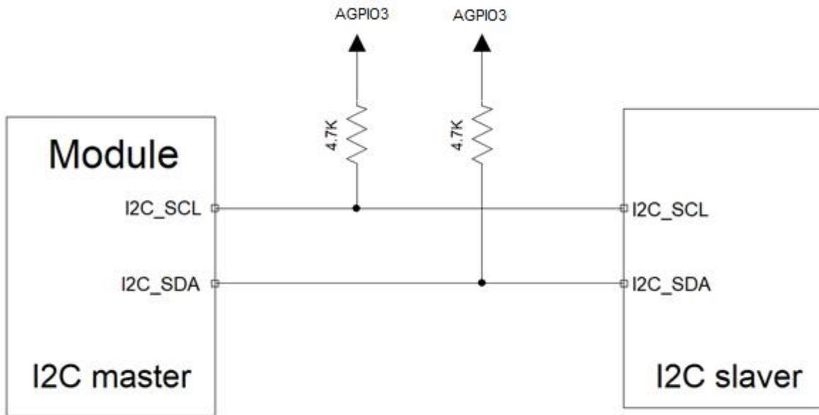
Air780EG 的 I2C 接口电压是 1.8V/3.3V 可配置，通过 PIN100 IO\_SEL 配置 IO 口电平，能够满足大部分外设的直接需求，但是如果要和 5V 或者以上电平的外设通信，那就必须要加电平转换电路：
