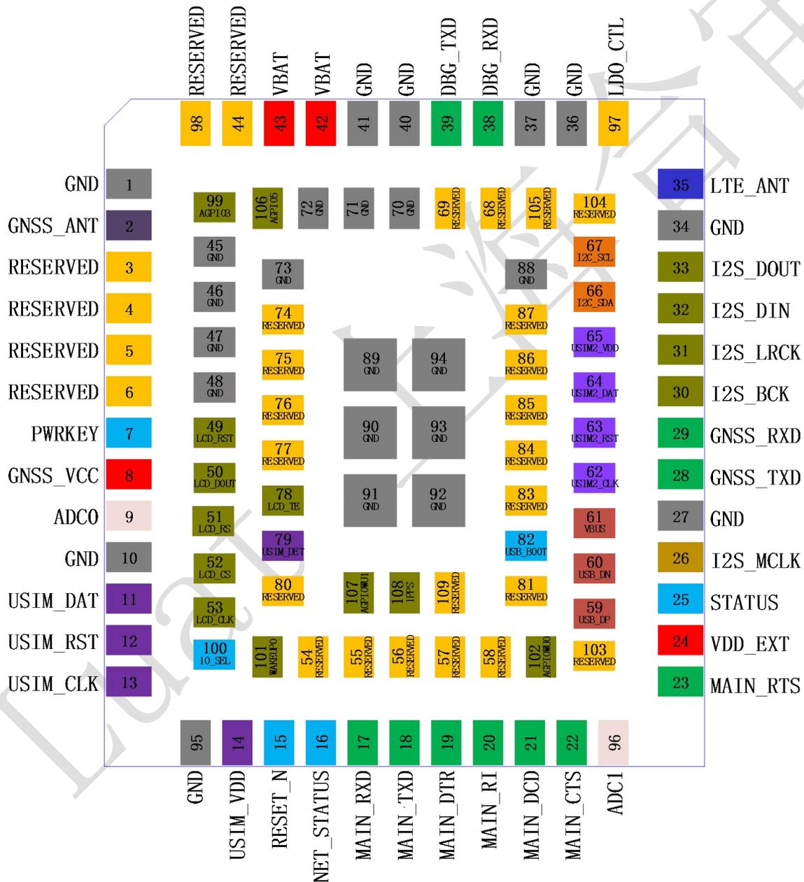
图表 2: Air780EG 管脚排列图 (正视图)
