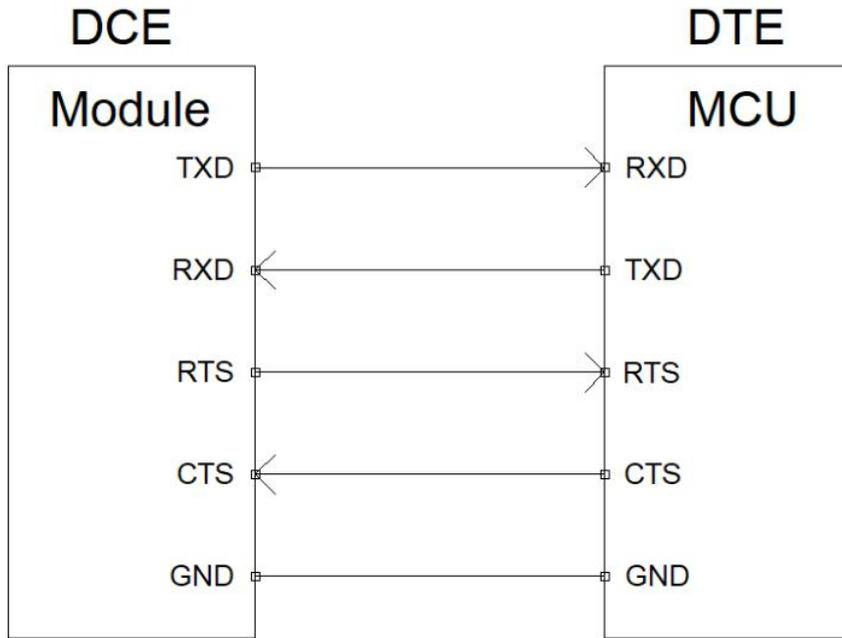
图表 8: 带流控的串口连接方式示意图
