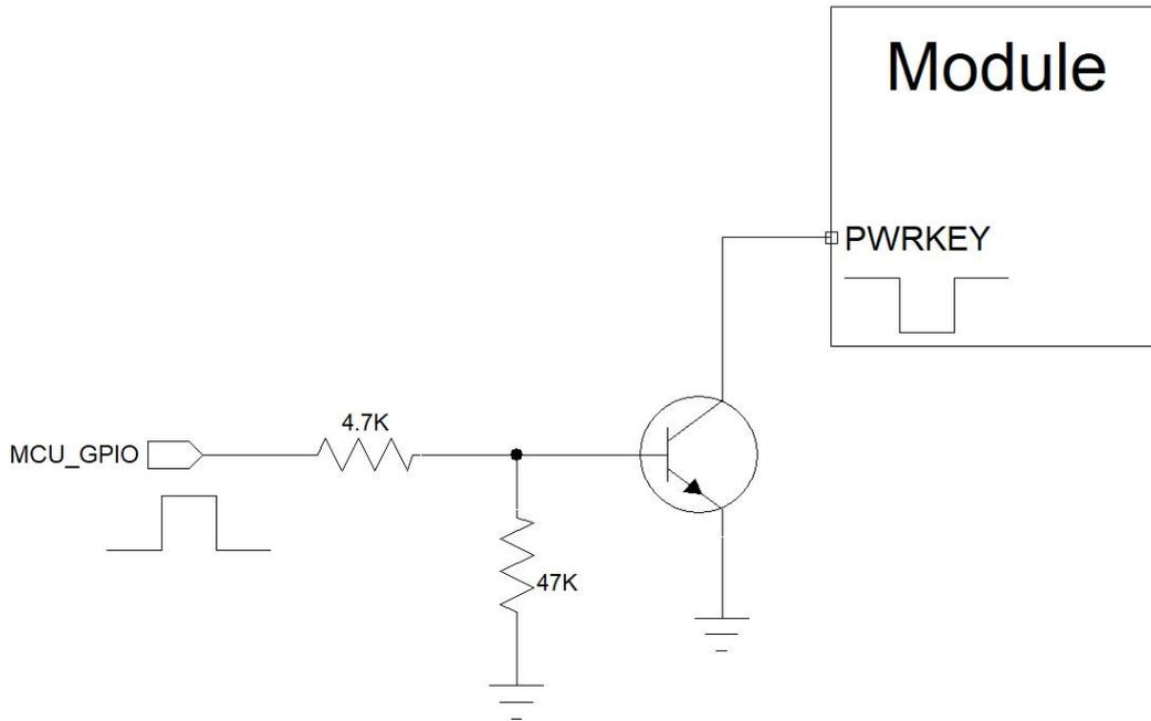
图表 5: 开集驱动参考开机电路
