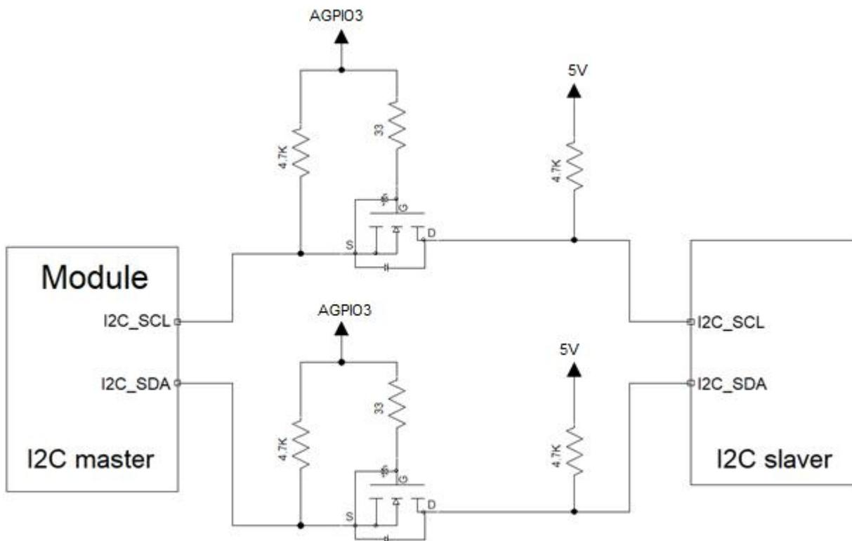
上图推荐用 AGPIO3 上拉，在不需要模块进入休眠的场景或者允许休眠掉电的场景也可以用 VDD\_EXT 上拉电平转换用的 NMOS 管必须选用结电容小于 50pF 的型号，推荐型号如下：
