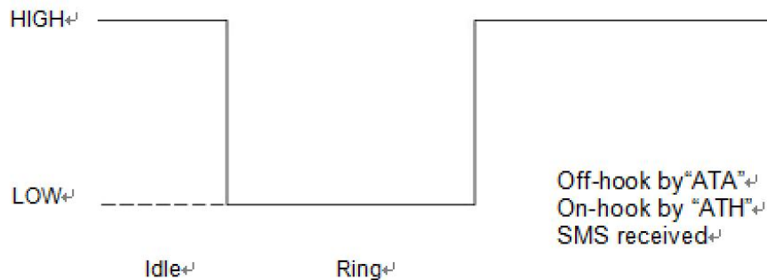
图表 12：语音呼叫时模块用作被叫方 MAIN_RI 时序
