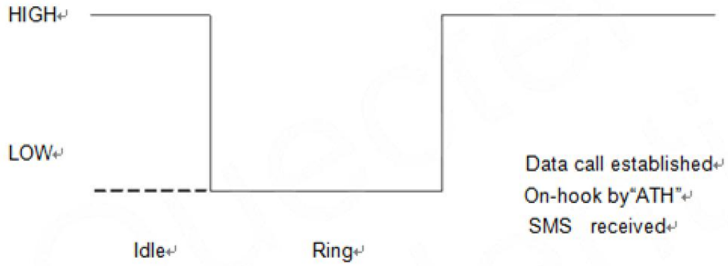
图表 13: 数据呼叫时模块用作被叫方 MAIN_RI 时序
